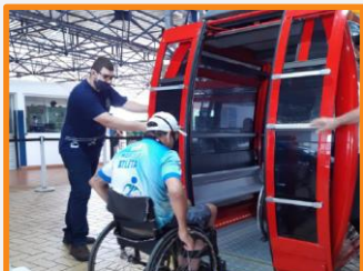
CABINES NA MESMA ALTURA DO PISO
