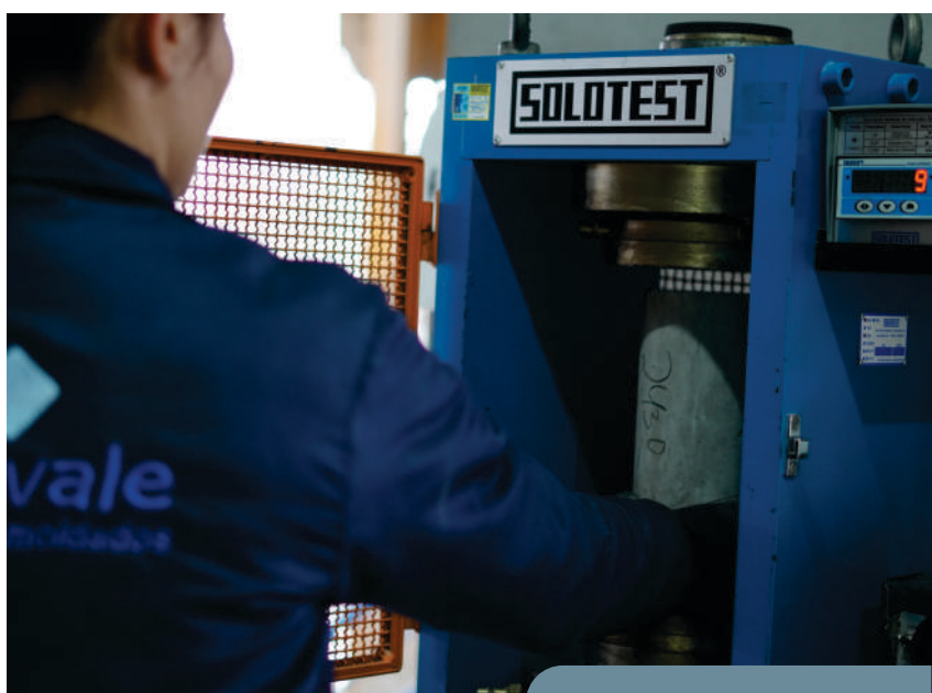
Laboratorista fazendo teste de resistência em corpo de prova.
