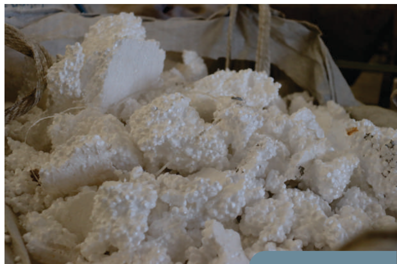
ESP recolhido do setor de consoles, alocados em BAG, destinados ao concreto leve.
